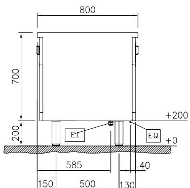
EI = Conexión eléctrica (energía)
